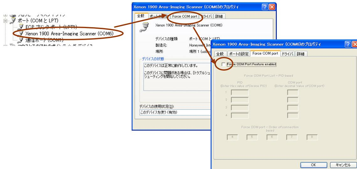
6. 「PID based list」もしくは「Order of connection based list」に設定値を入力し OK をクリックしてください。
